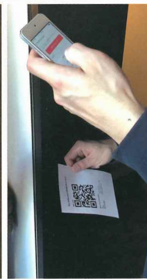
130台iPod touchを1台ずつ客室に紐付けるため、初期設定をQRコードを読み込むことで自動で行えるよう開発。手入力で2～3日かかっていた初期設定が、1日かからず完了した。
